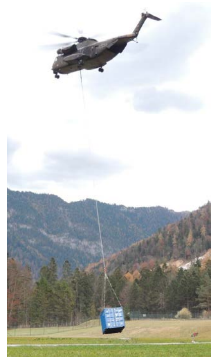
CH-53 der Bundeswehr mit 90 kN Transportleine TLM
